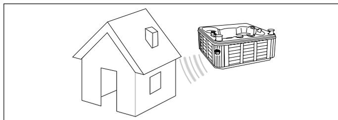
Le module in.touch devrait être installé aussi près que possible de la maison pour optimiser la puissance du signal. Il est recommandé d'installer le côté du spa muni du module in.touch face à la maison afin d'accroître le signal. L'eau entre le module in.touch et le routeur pourrait réduire radicalement le signal.
