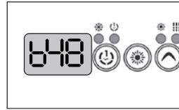
Les valeurs affichées par le système correspondent à 80 % de l'ampérage maximal du disjoncteur différentiel de fuite à la terre (GFCI/RCD).
