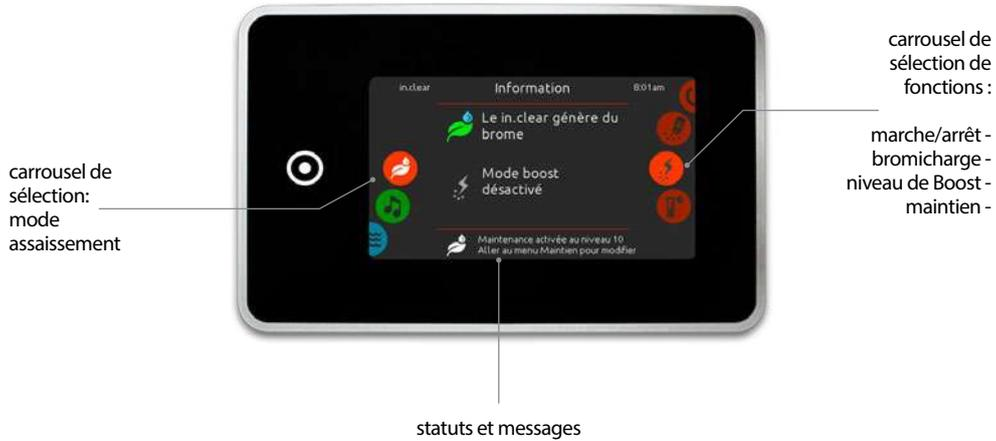
Pour sélectionner le mode d'assainissement, faites tourner le carrousel gauche vers le haut ou vers le bas jusqu'à ce que l'icône du mode assainissement s'allume au milieu de l'écran.
