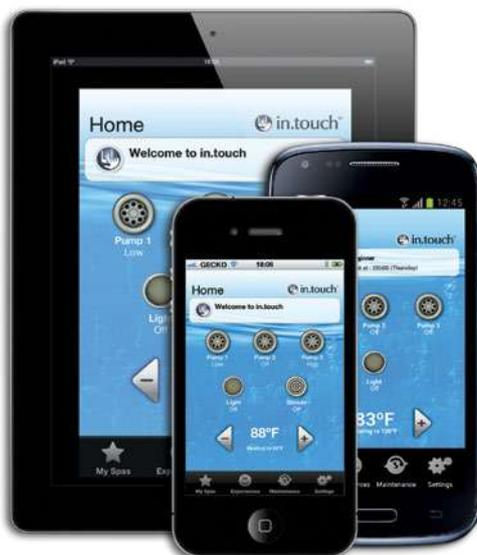
Contrôlez toutes les fonctions d'un spa à partir d'un téléphone intelligent iOS ou Android ou encore, d'une tablette, à l'aide d'une de nos applis mobiles **in.touch**. **in.touch home** vous permet de contrôler un spa en utilisant le réseau wifi de la maison, et **in.touch world** se sert d'Internet pour contrôler un spa où que vous soyez.
