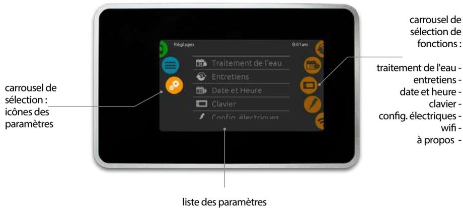
Pour sélectionner le mode paramètres, faites tourner le carrrousel gauche vers le haut ou vers le bas jusqu'à ce que l'icône du mode paramètres s'allume au milieu de l'écran.
