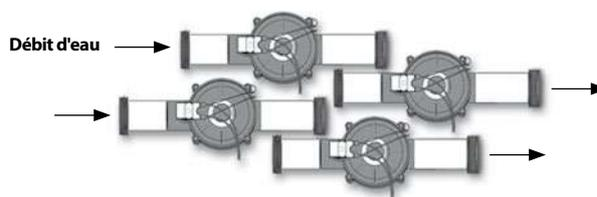
Les valves sont branchées à la tuyauterie du module de puissance du Pulsar.
