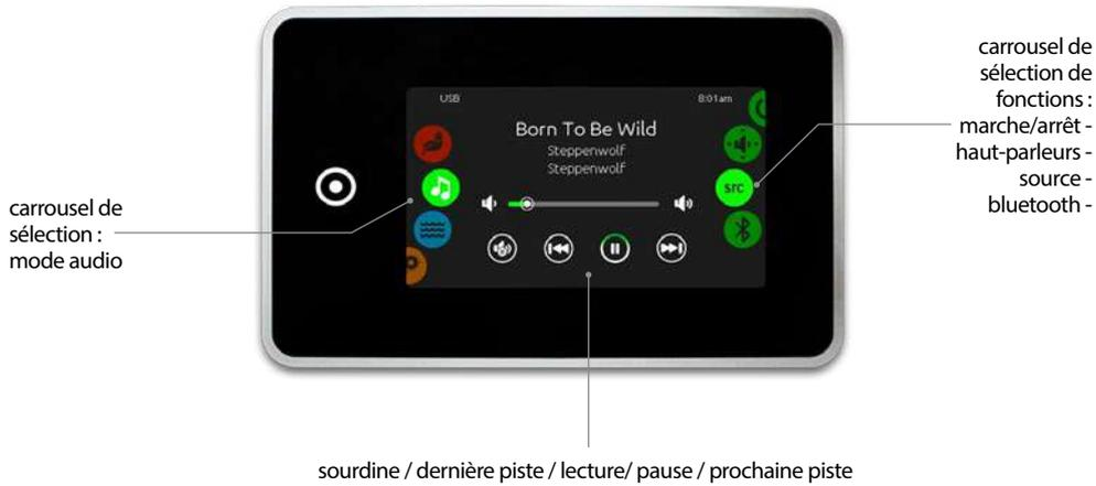
Pour sélectionner le mode audio, faites tourner le carrousel gauche vers le haut ou vers le bas jusqu'à ce que l'icône du mode audio s'allume au milieu de l'écran.
