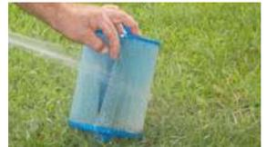
**Ne jamais utiliser un détergent alcalin ou un nettoyeur haute pression pour nettoyer le filtre!**
