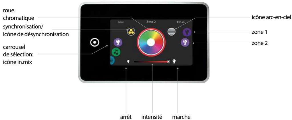
Par défaut, le in.mix sélectionne la Zone 2 lorsque vous accédez au menu. Pour sélectionner le mode couleur, faites tourner le carrousel gauche vers le haut ou vers le bas jusqu'à ce que l'icône du mode couleur s'allume au milieu de l'écran :
